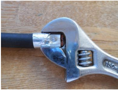
レンチではさむことにより、ビスで押し込んでも導線部分の幅が広がらずに済んでいます。
