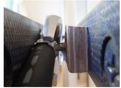
万力の間から見た状態です。この状態で、右側から押し付けていき、ビスの先端で圧着します。
