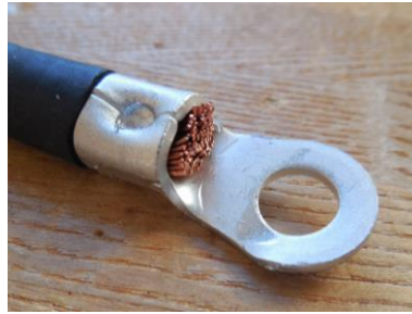
圧着の完成。なかなかいい感じです。導線が圧着端子から抜けないう、ハンダで固定することにしました。
