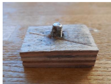
手作りの「圧着工具」です。木片にビスを埋め込みました(木片の下からねじ込んでいます)。
