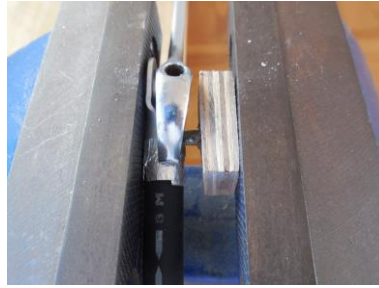
レンチではさんだ圧着端子と導線部分を万力の中に置き、木片に埋め込んだビスで押さえつけました。
