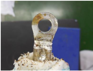
さらにガスバーナーであぶるとハンダが抜け、冷えて固まれば導線が抜けなくなります。
